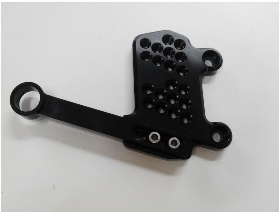
Montare l'arretratore 4Racing e regolare la staffa marmitta (Montando i gommini della staffa originale nella nuova) e stringere bene la vite della marmitta e le viti sull'arretratore.
