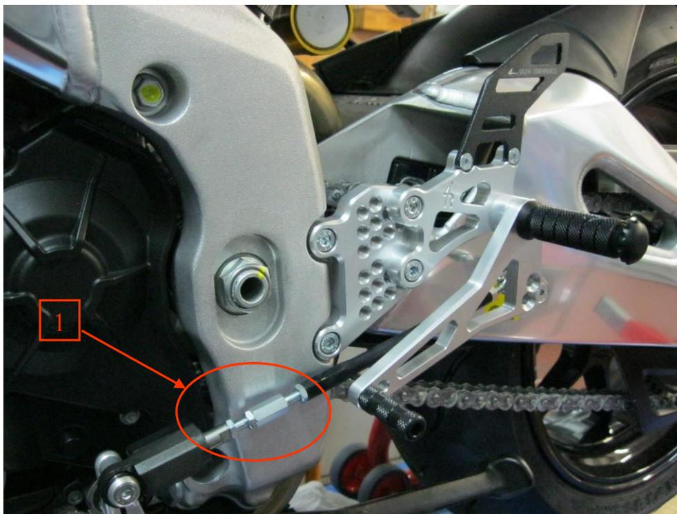
Smontare la pedana originale e montare l'arretratore e il montante cambio 4Racing con le viti in dotazione.
