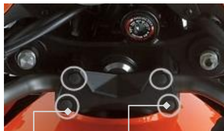
Photo 2 Vis à démonter et à remplacer
